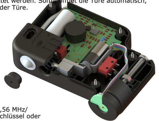
Mit dem FIT Schloss kann mit einem beliebigem RFID-Schlüssel (Karte/Chip) 13,56 MHz/ Mifare, jeder freie Schrank belegt werden. Nur der zum Schließen verwendete Schlüssel oder die Programmierkarte, welche als Master dient, können das Schloss wieder öffnen. Nach dem Öffnen, kann der Schrank von jedem beliebigen RFID Schlüssel belegt werden. Der Schrank wird zugehalten und die Karte, mit welcher der Schrank versperrt werden soll wird ebenfalls angehalten, bis das LED rot leuchtet.
